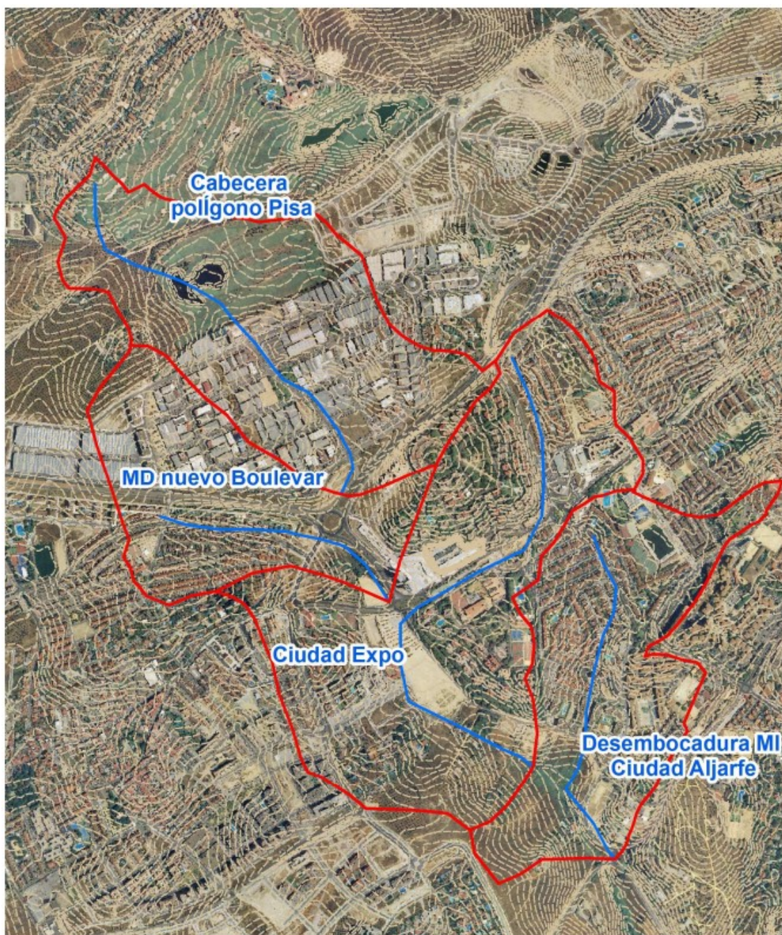
Figura 2: Cuencas de aportación contempladas en el estudio hidrológico del proyecto de “Defensa contra inundaciones en el entorno del arroyo Porzuna. Término Municipal de Mairena del Aljarafe. (Sevilla)”.
