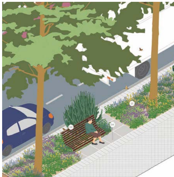
SbN 9.2 Creación de alcorques corridos. Fuente: Manual de Soluciones Basadas en la Naturaleza. Plan de Fomento y Gestión de la Biodiversidad de la Ciudad de Madrid.
