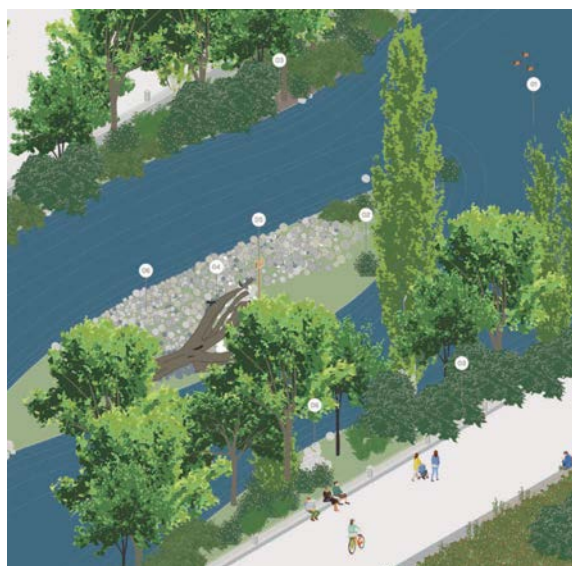
SbN 2.1 Naturalización de cauces confinados construidos. Fuente: Manual de Soluciones Basadas en la Naturaleza. Plan de Fomento y Gestión de la Biodiversidad de la Ciudad de Madrid.
