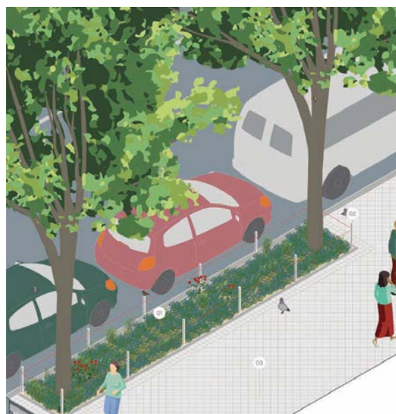
SbN 9.1 Conexión de alcorques dos a dos. Fuente: Manual de Soluciones Basadas en la Naturaleza. Plan de Fomento y Gestión de la Biodiversidad de la Ciudad de Madrid.
