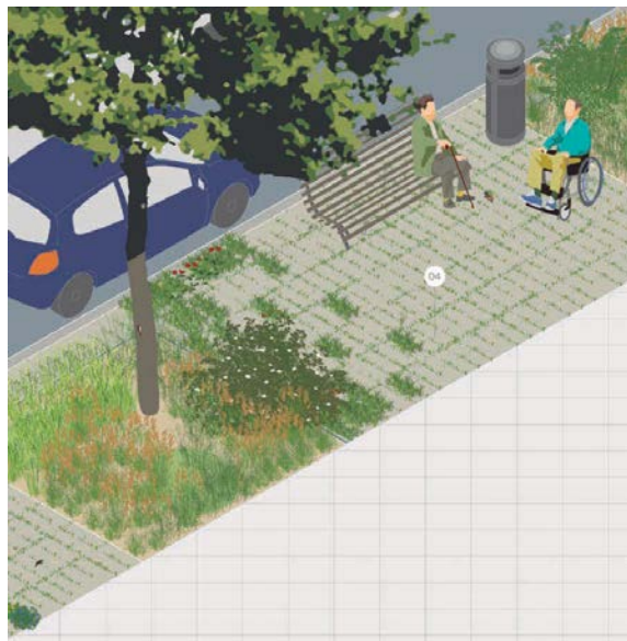
SbN 12.1 Instalación de pavimentos permeables con vegetación.
