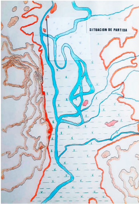
Esquema I. Se representa la llanura de inundación con los cauces principales del río constreñida por la curva de nivel de 20 m.s.n.m. Se observan retazos de una terraza primitiva en la llanura a salvo de las grandes inundaciones.
